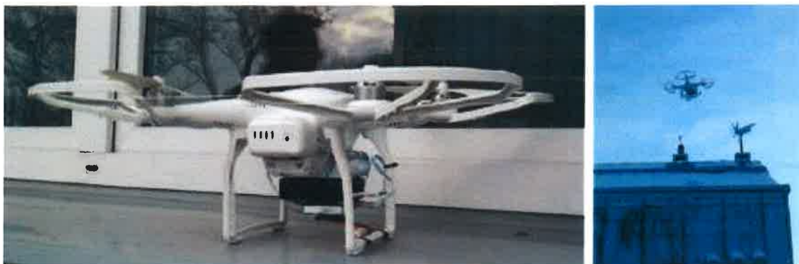
Il. 11. Dron z miernikiem zapylenia powietrza – PM 2,5 i PM 10, pomiary przy LAEiOE, fot. autor
